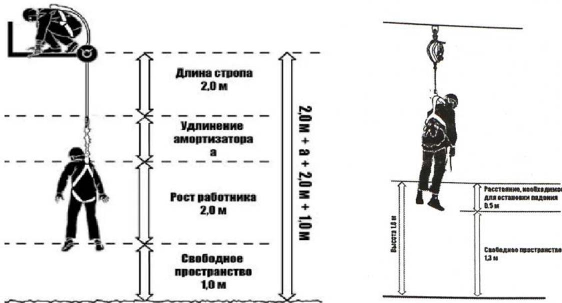
Для обеспечения безопасности важно удостовериться в наличии свободного пространства под пользователем на рабочем месте перед каждым случаем применения, т.е. чтобы в случае падения не было возможно столкновение с землей или иными предметами на траектории падения.
