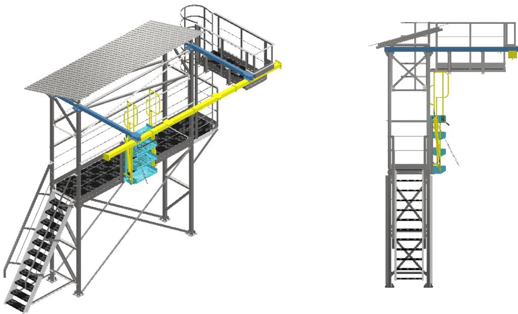
Несущая конструкция представляет собой сборно-сварную конструкцию из стального профиля.
